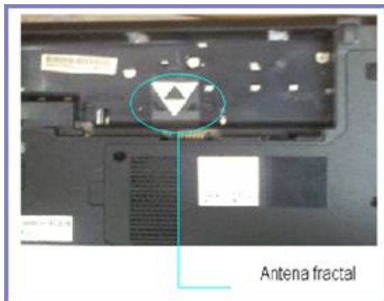
Fig. 8 Fotografía de la antena fractal implementada en la laptop
