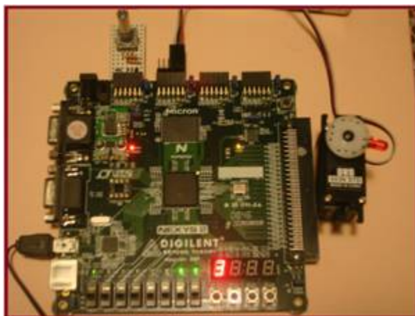
Foto 3. El servo muestra una posición de casi 0° (led apuntando hacia la derecha) que es la posición 3 de las 32 posiciones programadas (del 0 al 31).
