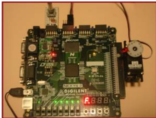
Foto 1. El servo muestra una posición de 180° (led apuntando a la izquierda) que es la posición 31, en el display F. en hexadecimal donde el punto indica la segunda vuelta para las posiciones de la 16 a la 31.
