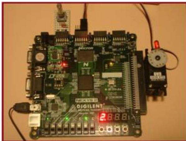
Foto 2. El servo muestra una posición de un poco más de 90° (led apuntando hacia arriba) que es la posición 18, en el display 2. en hexadecimal donde el punto indica la segunda vuelta para las posiciones de la 16 a la 31.
