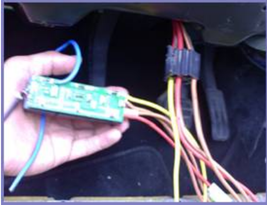
Figura no. 9 Conexión y alimentación de los Relevadores.
