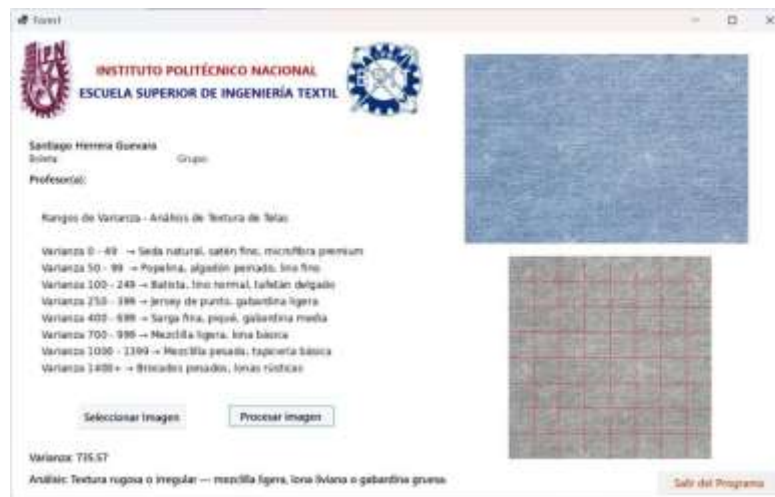
Figura 3. Interfaz del programa tras el cálculo de varianza e interpretación de la textura de mezclilla.
