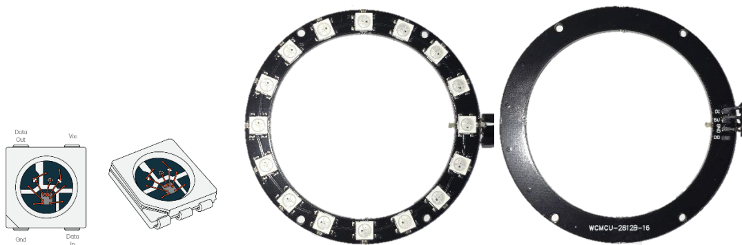
Figura 1. LED WS2812B y módulo comercial WCMCU-2812B-16 (frontal y posterior).
